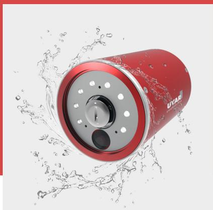
Le RWC 2.0 peut être utilisé pour la surveillance des processus dans les zones de production soumises à une pulvérisation importante de lubrifiants réfrigérants. Une vitre rotative spéciale, située devant l'objectif de la caméra, permet d'évacuer tous les liquides de refroidissement et les copeaux grâce à son mouvement de rotation..
