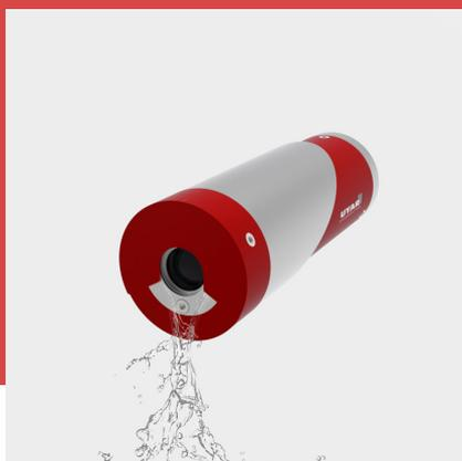
L'EAC 2.0 permet la surveillance visuelle des zones d'usinage soumises à des projections d'émulsions de lubrifiants réfrigérants faibles à moyennes. Un dispositif d'air comprimé spécial crée un rideau d'air constant devant l'objectif de la caméra, repoussant ainsi le liquide de refroidissement et les copeaux.
