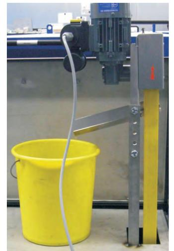
Déshuileur à bande BS sur une installation de dégraissage
