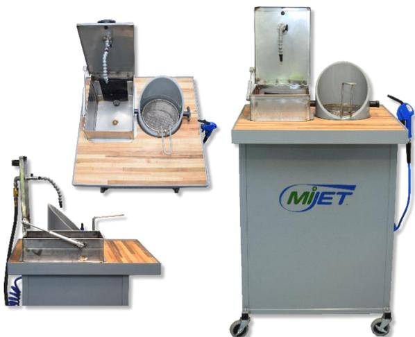
Poste de nettoyage MiJET de 203 mm de diamètre – avec récipient pour solvant et panier pour pièces
