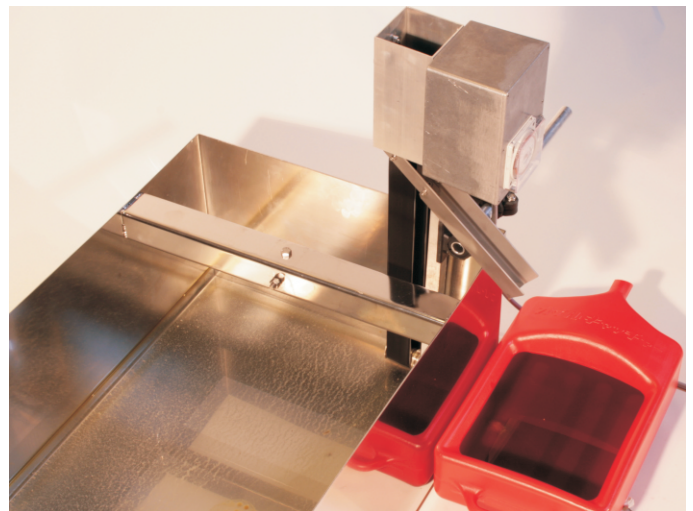
Après quelques minutes d'utilisation, la surface est débarrassée de l'huile
