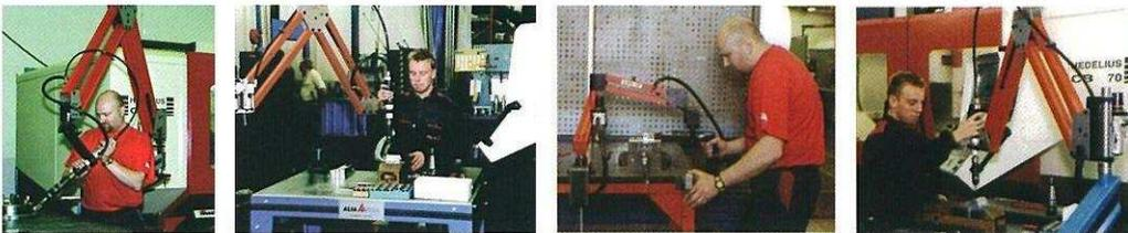
Le bras SL® Multi est une puissante machine à tarauder avec 2 modules de vitesse pour une flexibilité maximale. Un vérin pneumatique facilement réglable permet des déplacements souples et précis.
